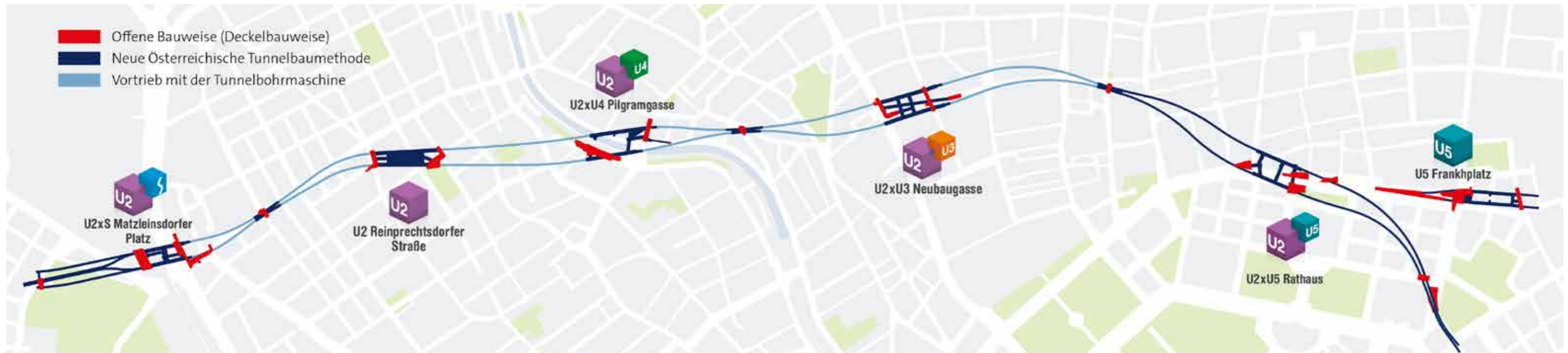
Übersicht Bauweisen Baulos U2/17 bis U2/21
