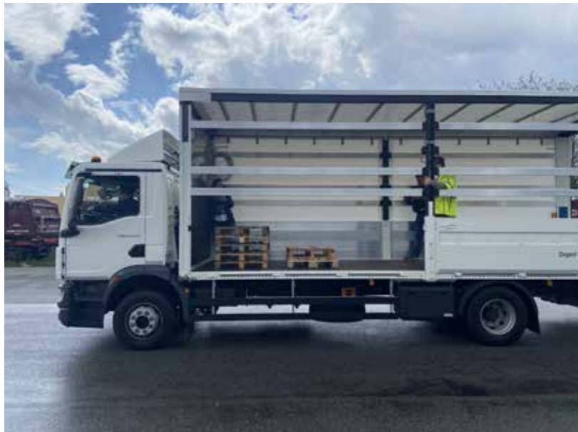
Durch die Simulation typischer Szenarien problematischer Ladungssicherung auf einem Demonstrationsfahrzeug sollen kontrolliert Ladungsverkippungen verursacht und mithilfe der Vibrations- und Schallsignale im Laderaum erfasst werden.
