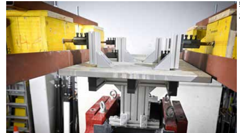
Beton wird mit dem Mobile Seismic Simulator systematisch zum Schwingen angeregt
