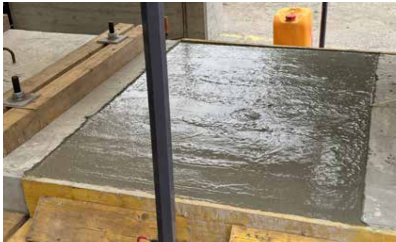
Ziel des Projektes ist es, einen Grenzwert für harmlose Erschütterungen beim Aushärten von Beton zu definieren
