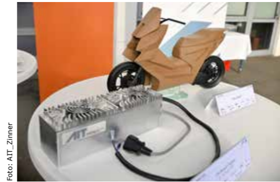
Der vom AIT entwickelte On-Board Charger
