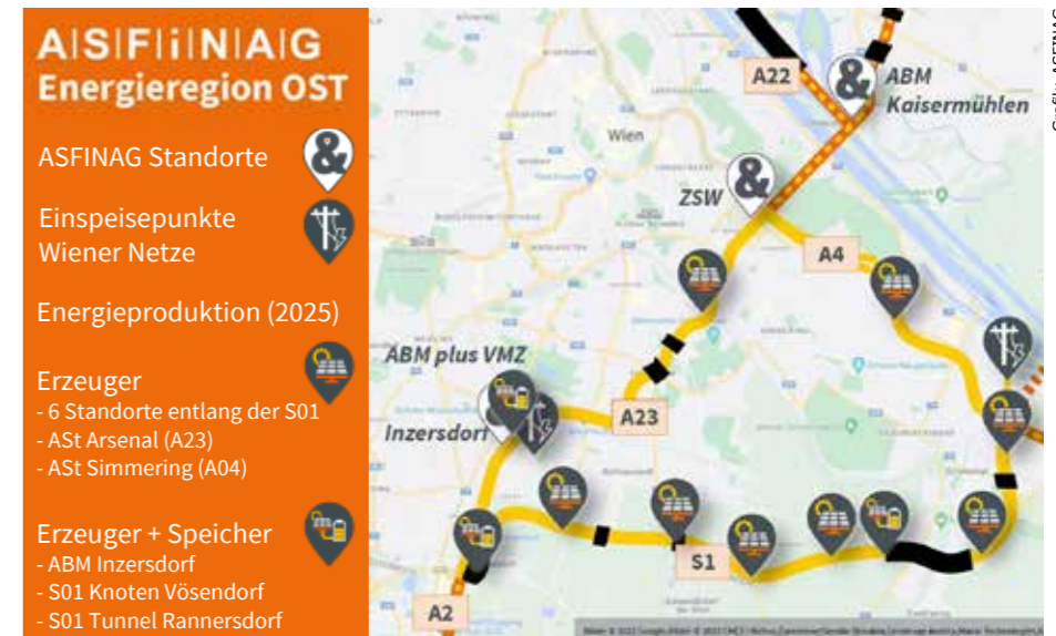
Der „Energiering“ Ost mit knapp 6.000 Kilowatt-Peak erstreckt sich über eine Länge von rund 38 Kilometern und ist die weltweit erste Installation eines privaten Energietransportnetzes mit erneuerbarer Stromproduktion mittels Photovoltaik und einer leistungsstarken Energiespeicherung für einen gesamten Autobahnabschnitt.
