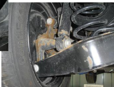
Abbildung 1: Korrosionsschäden am Fahrwerk
